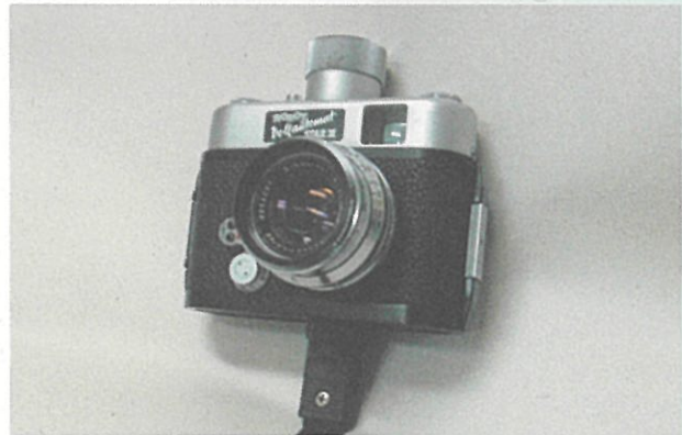
5-4 ロボットスターII/50 (昭和29年:東ドイツ、ロボット電子写真工業) (W) 11 (D) 5.5 (H) 10
