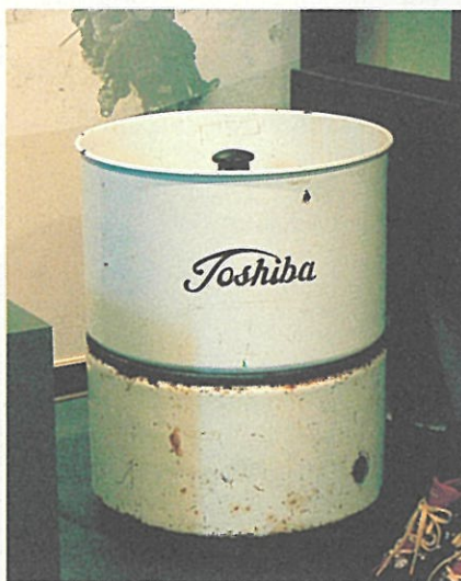
4-(1)-5 丸型電気洗濯機 (直径)45(高さ)58 (上村四郎氏蔵) 電気洗濯機は当初、「丸型攪拌(か くはん)式洗濯機」であったが、 昭和28年に三洋電機が日本最 初の回転翼で水流を起こす「噴 流式洗濯機」を発売。
