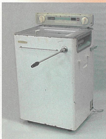
4-(1)-6 電気洗濯機 (W)52(D)42(H)90 (八戸市南郷歴史民俗資料館蔵) 右側についたハンドルを回すと 2本のローラーが回転し、洗濯 物をはさみこんで脱水した。昭 和35年には二槽式脱水乾燥洗 濯機が三洋電機と松下電器産業 から発売された。
