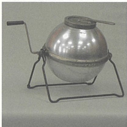
4-(1)-4 手回し洗濯機 (W)50(D)33(H)37 (青森県立郷土館蔵) 洗濯板から電気洗濯機への過渡 期にあらわれたもの。ボール型 の容器に衣類と洗剤を入れてハ ンドルを回して洗った。
