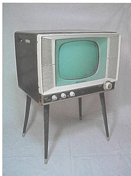
4-(1)-2 白黒テレビ<八欧電気、14-SB> (昭和36年:増田公寧氏蔵) (W)58 (D)43 (H)83 音声を画面中央で立体交差させることで音響効果を発揮する機能を備えており、「Xラインテレビ」と呼ばれた。
